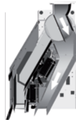
Положение БАЙПАСА при калибровке нуля
