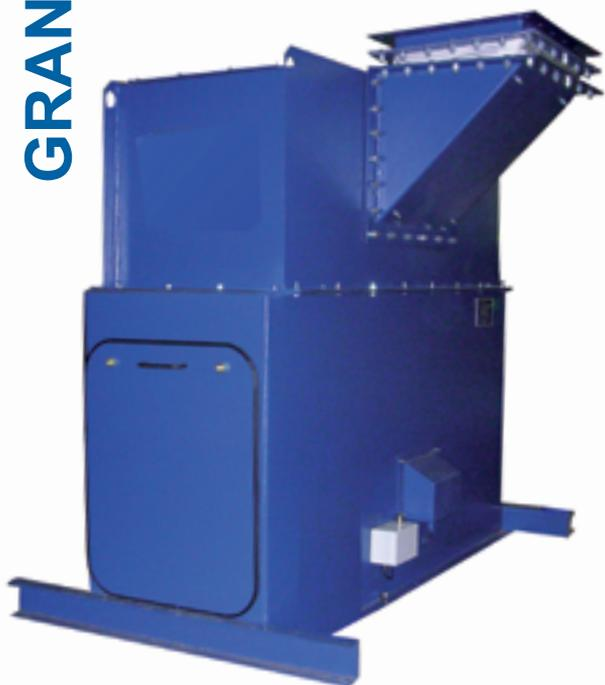
**Н**епрерывное взвешивание хорошо текучих мелко гранулированных продуктов. Полностью закрытая жесткая конструкция с каналом балансировки давления. Не чувствителен к забиванию продуктом, маятниковая система измеряет только горизонтальную силу. Прост в обслуживании, отсутствуют подвижные части. Легкое встраивание в тракт подачи продукта. Износостойкое покрытие направляющего канала продукта и ударной пластины.
