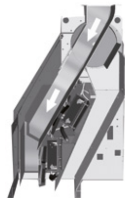
BY-PASS in Stellung: Förderstärkenmessung
