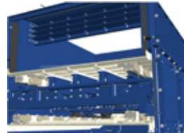
Spezialschienen mit Einlaufverwiegung (Einlaufbereich)
