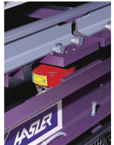
Wägebrücke mit digitaler Wägezelle
